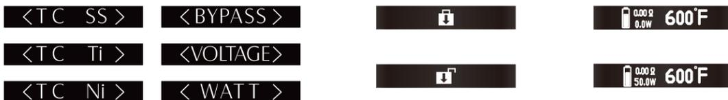
Appuyez simultanément sur les boutons «+» et «-» pour sélectionner les modes VW, VV, Bypass et TC (Ni, Ti, SS). Appuyez sur le bouton “+” ou “-” pour sélectionner les modes,
